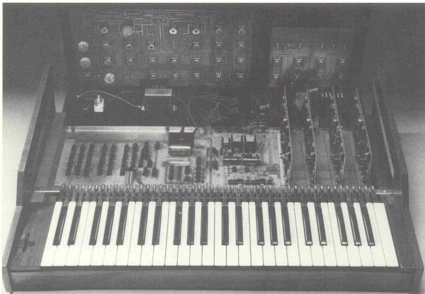
Bild 1. Die Verbindung der Platinen untereinander. Die VCO-Platinen (PS 7) werden über Vielfachstecker mit der Mutterplatine (PS 4) verbunden.
